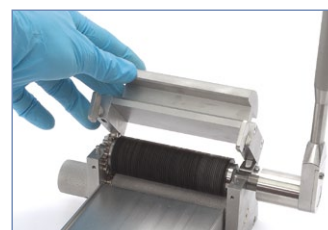
Capac mobil pentru eliberarea mostrelor de piele care au fost preluate de rola cu lame, în timpul procesului de expandare.
